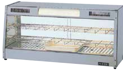
⑤ ホットショーケース NH-403 H-10 直 /元払・1台 寸法:900×300×415 / 100V・740W 1台 ¥195,000 611-3402 棚板2段可変 ケース内は50~80℃まで温度調節自由自在 耐久性に優れたステンレス製
