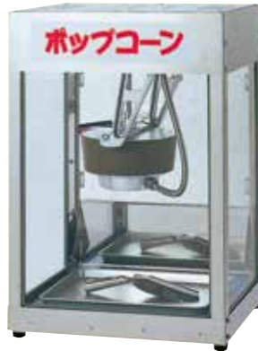
② ポップコーン機 POP-4F N-6 直 /元払・1台 寸法・450×350×650 / 100V・1200W 1台 ¥230,000 611-6604 能力・3分毎に120g(六角カップ4杯、三角カップ6杯)
