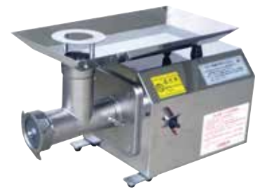
⑦ 電動ミートチョッパー OMC-12C-2 H-7 直 納3 寸法・305×540×320/100V・200W 1台 ¥215,000 612-0012 標準仕様・3.2mmプレート付/能力・1時間100~150kg 牛、豚、鶏肉、魚肉等の挽肉や豆類、野菜等食品全般
