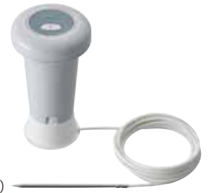
防水型無線温度ロガー(分離タイプ) ⑮ SK-320BT-C H-5 直納3 寸法 1台 ¥15,000 712-0320 測定範囲・-50~150℃ 測定精度・±1.0℃(-0.1~40.0℃) ±1.5℃(-15~0℃ / 40.1~65℃) ±1.0℃(-30~15.1℃ / 65.1~150℃) ±1.0℃(-50~30.1℃) 使用環境条件・-15~60℃ (一般空気測定の場合やセンサパイプのみ水没の場合は-50~150℃) 【携帯端末の動作条件】 対応OS Ver. iOS 13以上、Android 9以上 無線機能:Bluetooth4.0以上搭載 ■携帯端末にインストールした専用アプリを使用して、記録データの取得をおこないます (Bluetooth機能が付いた携帯端末が必要です) ■本体と携帯端末は複数台で同時接続が可能で複数の測定場所の温度データを表示、取得できます
